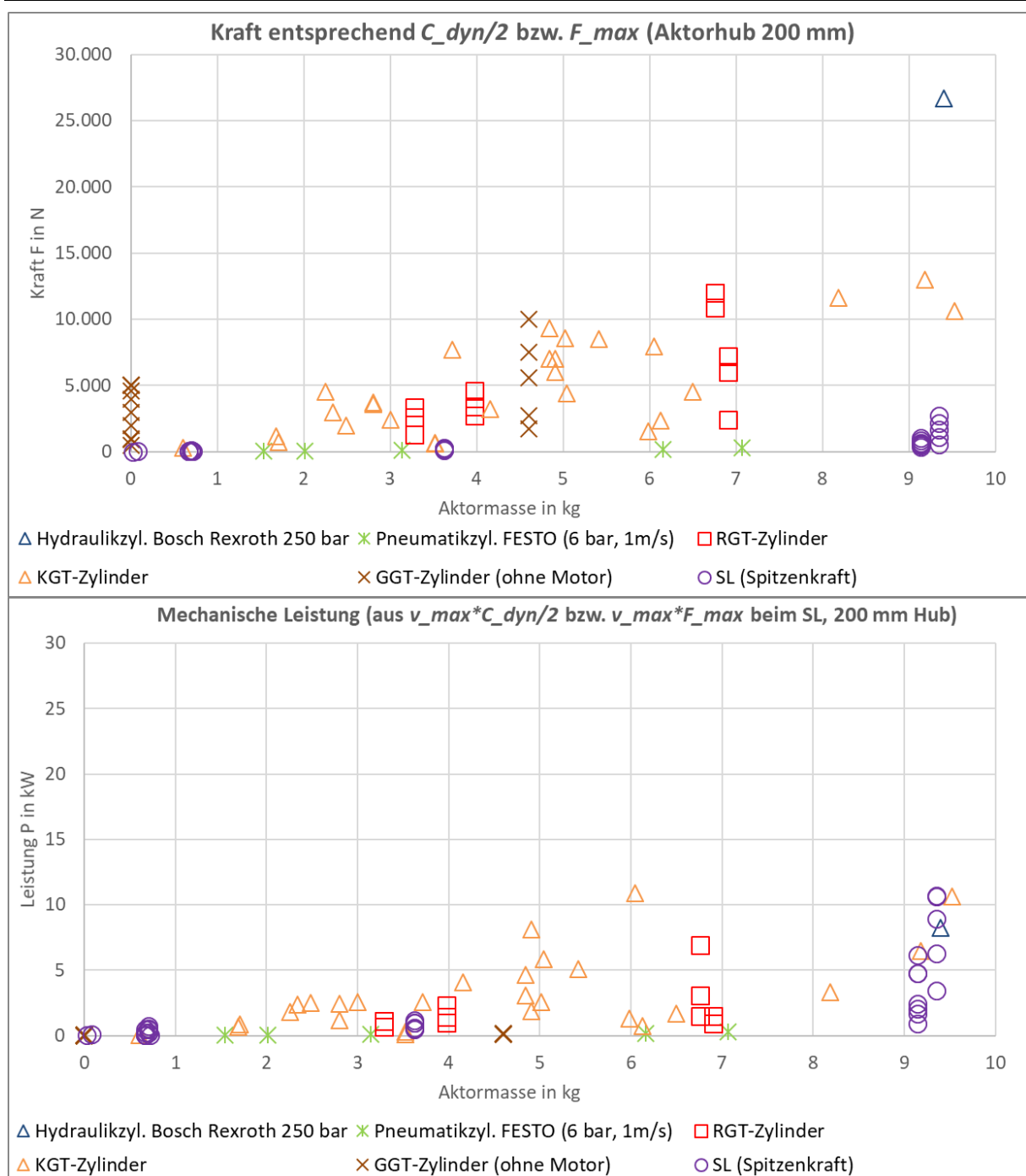
Abbildung 47: Aktorkraft und -leistung über Aktormasse bei hoher Ausnutzung (Elektrozylinder teilweise mit und ohne Antriebsmotor) – bis 10 kg Aktormasse
