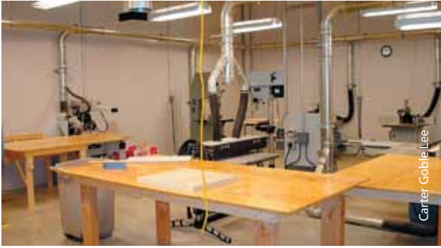
Figura 7. Ejemplo de taller para la formación profesional con ventilación de seguridad adecuada.
