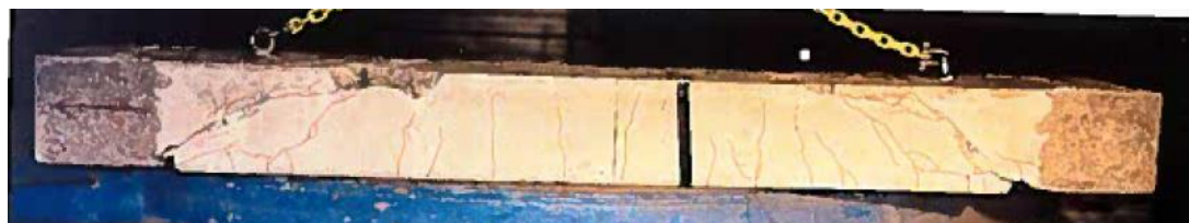
(b) Identisk balk efter belastning med luftstötstång till skjuvbrott
