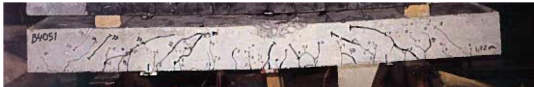
(a) Balk efter kvasi-statisk belastning till böjbrott
