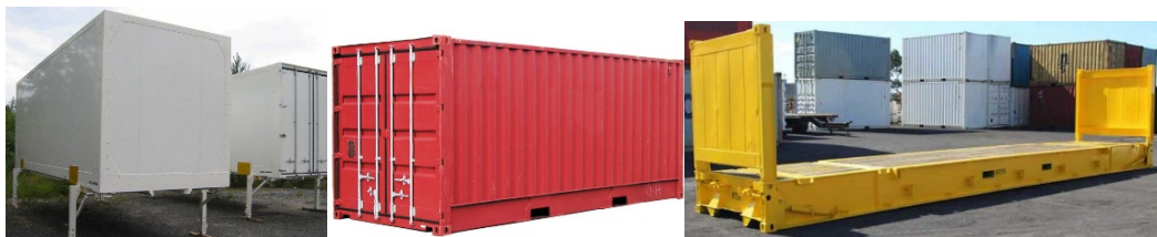
Figur 2.2. Från vänster till höger: växelflak, TEU container, flat-rack (hopfällbar).
