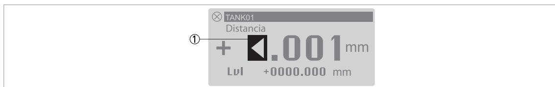
Figura 6-2: Símbolo de error: el número de dígitos y decimales no es suficiente para los datos de medida
