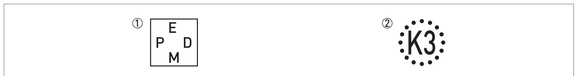
Figura 2-4: Símbolos referentes al material de la junta suministrada (en el lado de la conexión a proceso)
